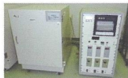
断熱温度上昇試験
