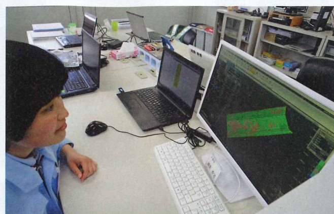
写真4 ■ 完成部の出来形計測も酒井氏が担う。誤差の許容値は法面が±7cm、平場が±5cmに対して、大半が許容値の20%内に収まる(画面の緑色の部分)
