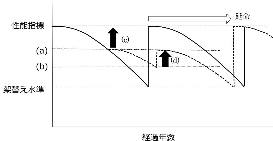
(イ) 補強水準 (口) 補修水準 (ハ) 補強工事 (二) 補修工事
